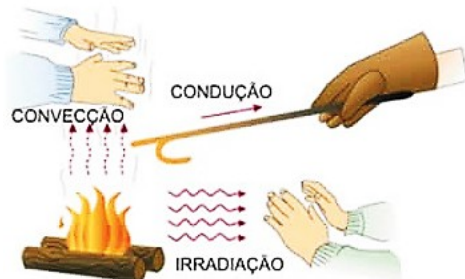
Figura 5 – Influência dos mecanismos de transmissão da energia
