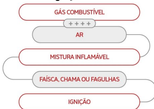
Figura 8 – Mecanismo de ignição de combustível gasoso
