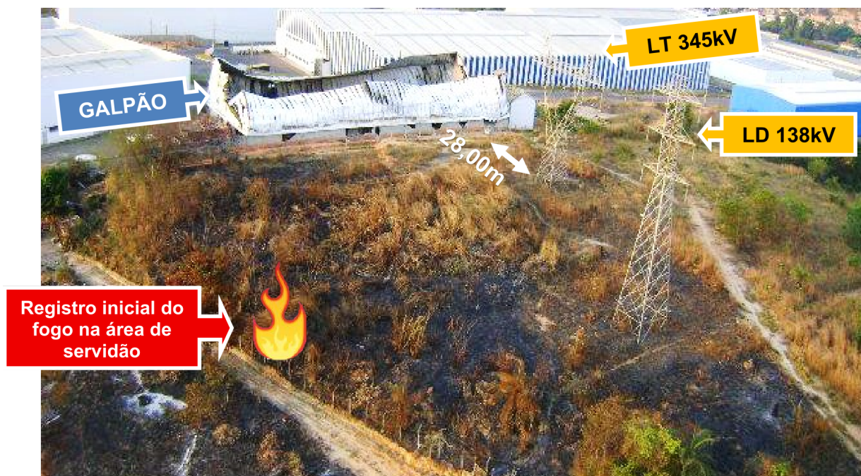
Figura 15 – Primeiro sinal de fogo na faixa de servidão por volta das 18:45
