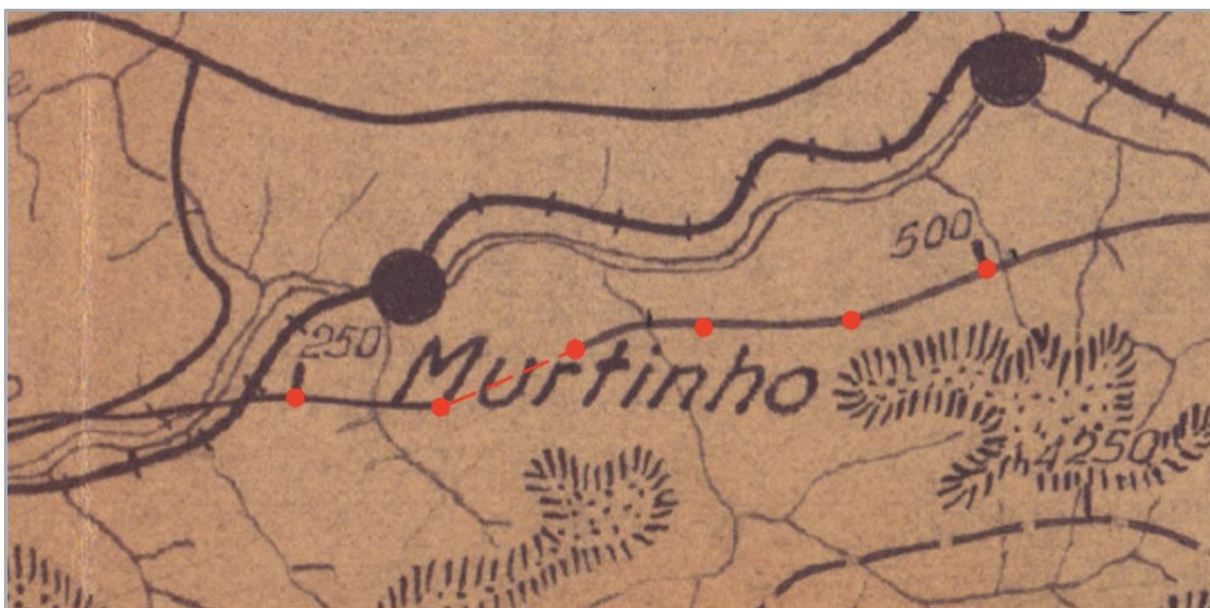
Figura 12: Recorte do projeto original da rodovia, com marcações intermediárias a cada 50 estacas entre as estacas 250 e 500 (Fonte: DNIT; Marcações do autor).
