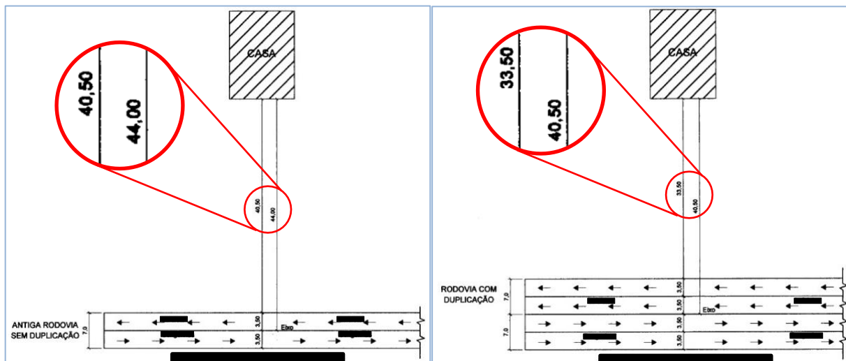
Figura 8: Recorte dos levantamentos topográficos apresentados pela Autora antes e após a duplicação da rodovia (Fonte: autos do processo).
