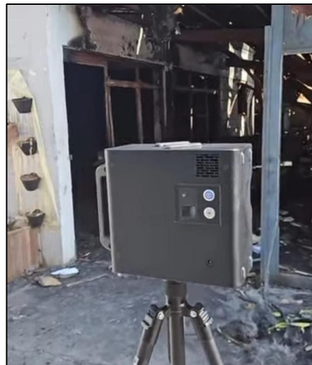
Figura 17 – Scanner 3D para mapeamento de ambiente. Fonte: Autoria própria
