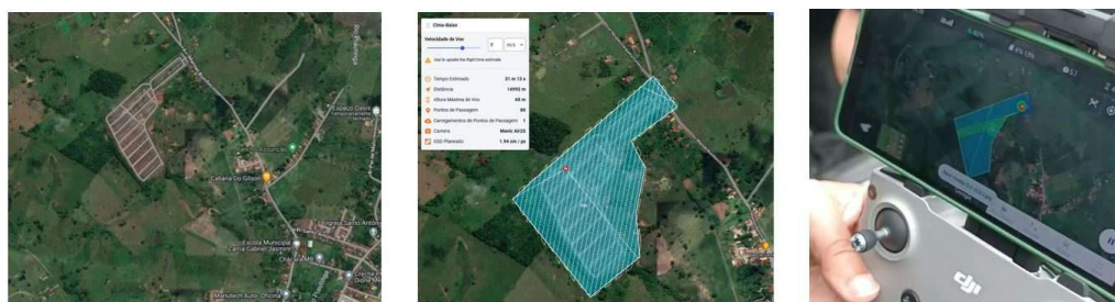
Figura 3: Confeção de plano de voo automatizado, com localização do empreendimento no Google Maps (à esquerda), traçado das rotas de voo (ao centro) e controle do equipamento (à direita) (autoria própria).
