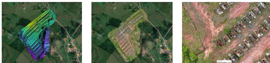
Figura 6: Produtos digitais obtidos, com MDE - Modelo Digital de Elevação (à esquerda), orthophoto (ao centro) e detalhe da orthophoto (à direita) (autoria própria).
