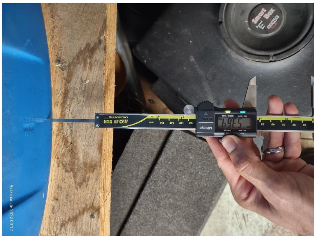
Figura 4 – Área da base de apoio é menor em relação a área da base do produto.
