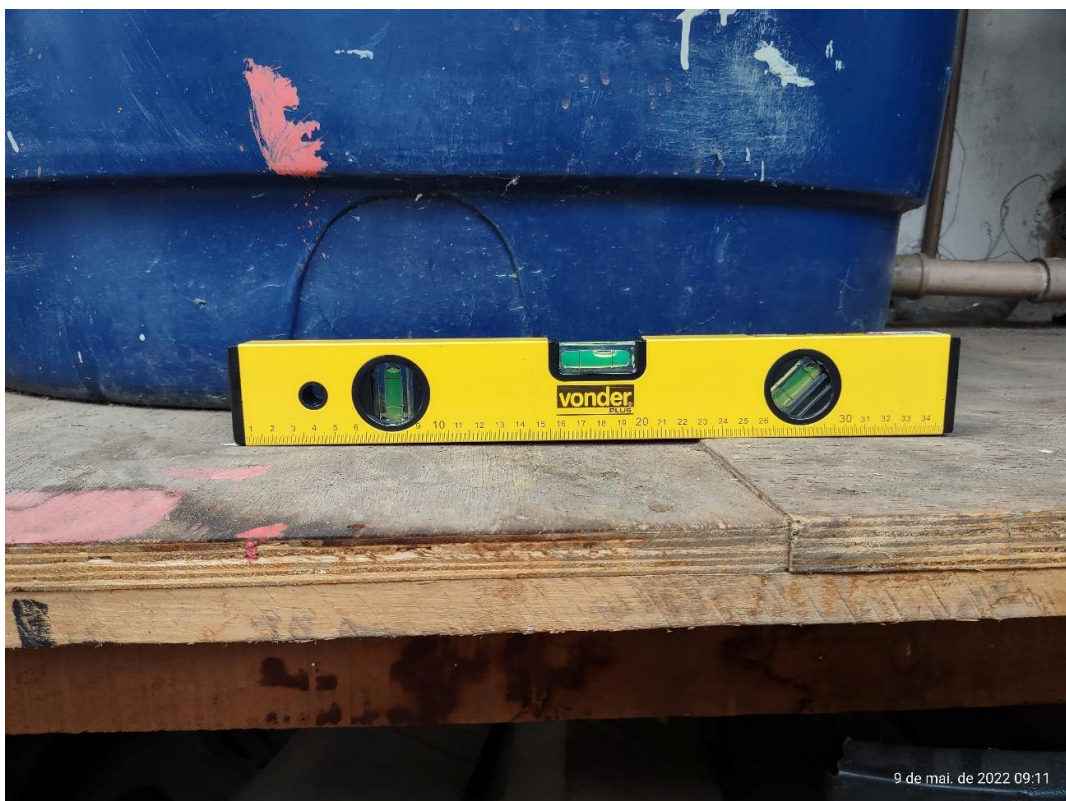
Figura 7 – Sem nivelamento adequado.
