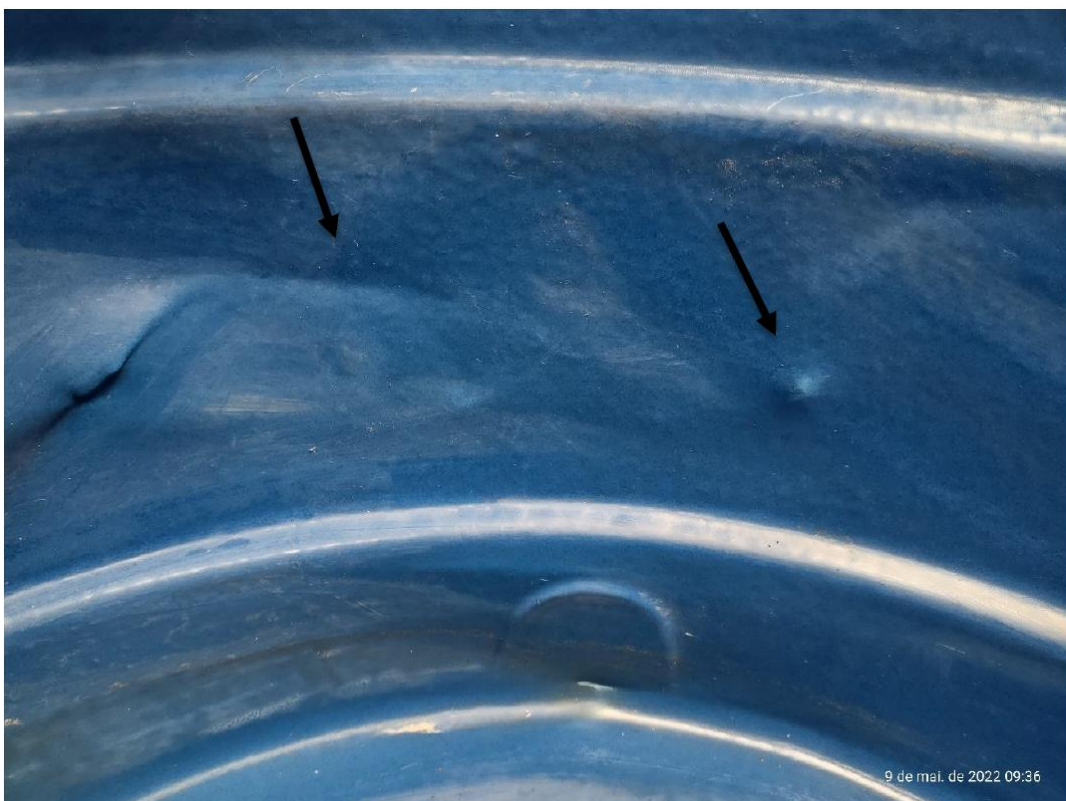
Figura 12 – Pontos de mais deformações.
