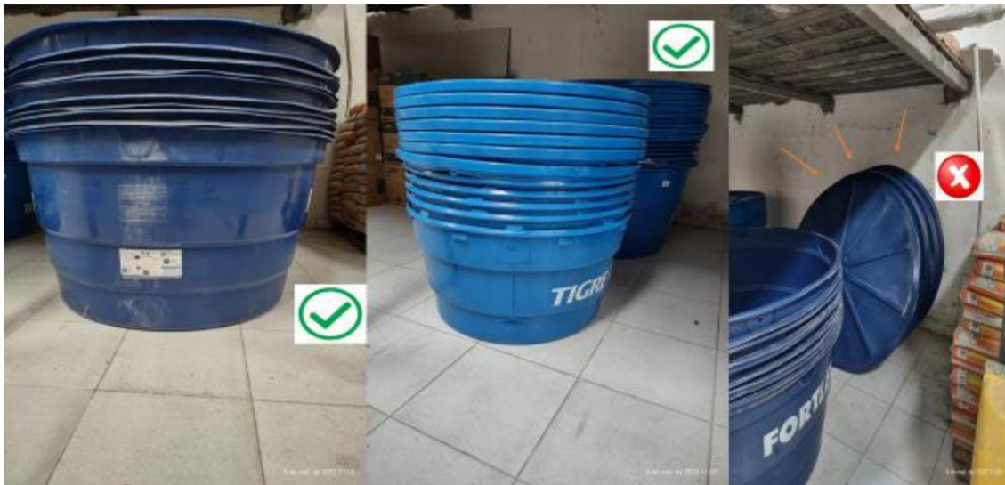
Figura 8 - Correto armazenamento dos produtos, exceto para as tampas com indicação das setas.
