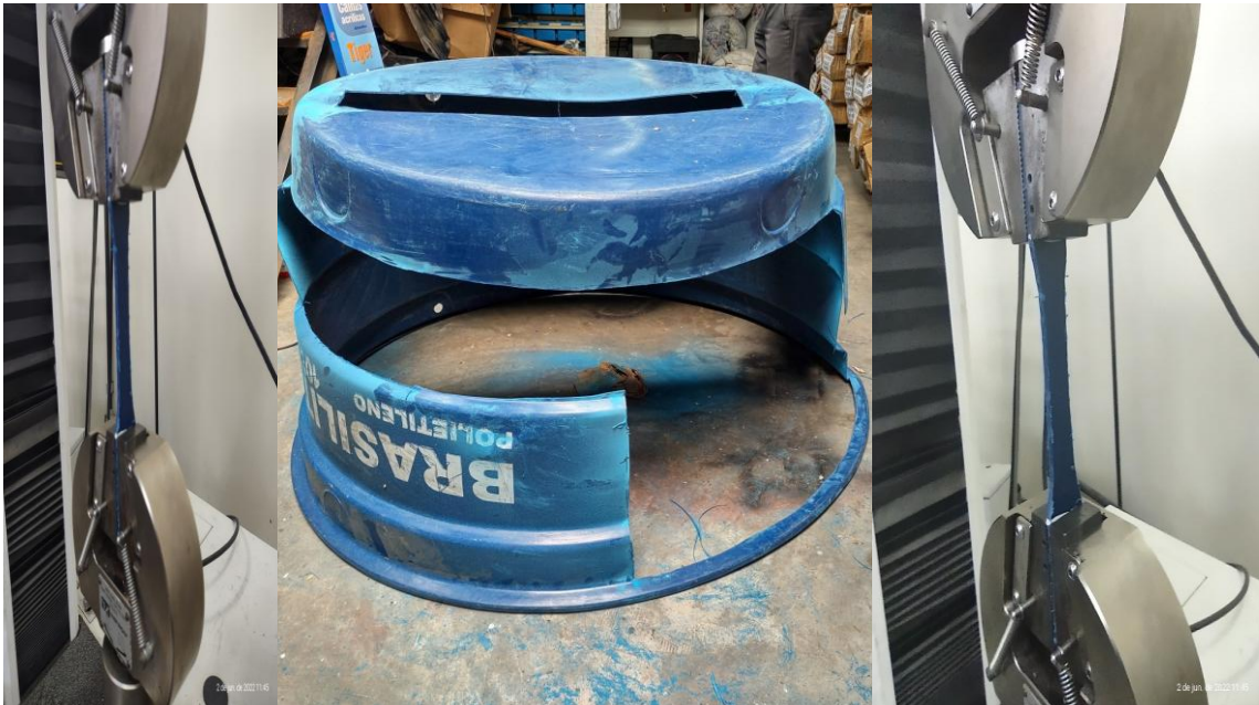
Figura 1 – Coleta de amostras do corpo polimérico para realizar ensaios de tração.
