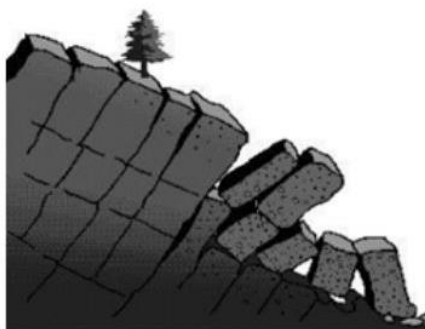
Figura 8 – Queda de blocos ( rock fall )
