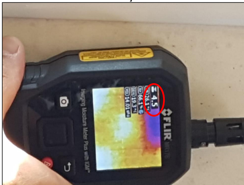
Figura 19: Índice de umidade próximo de zero, indicando inexistir infiltrações
