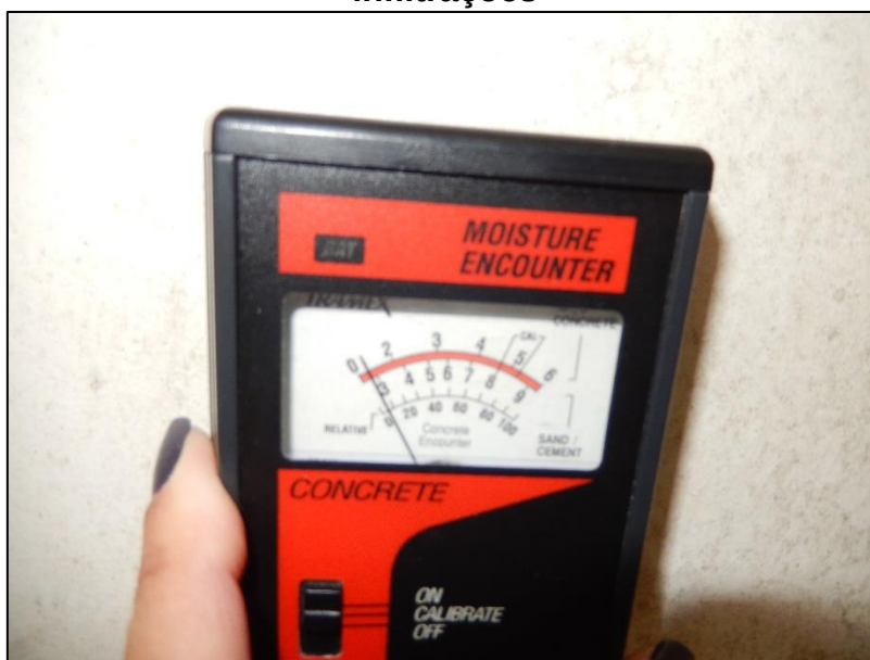
Figura 16: Índice de umidade próximo de zero, indicando inexistir infiltrações
