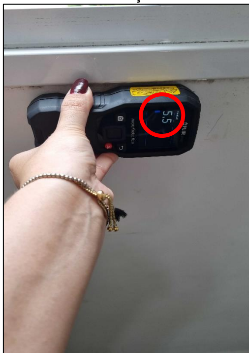
Figura 27: Índice de umidade próximo de zero, indicando inexistir infiltrações
