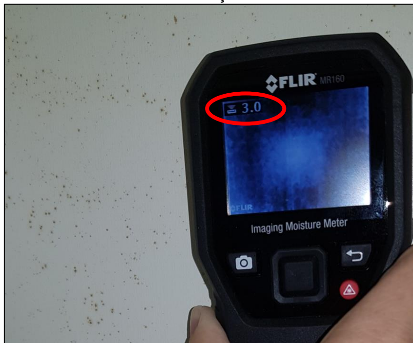
Figura 22: Índice de umidade próximo de zero, indicando inexistir infiltrações
