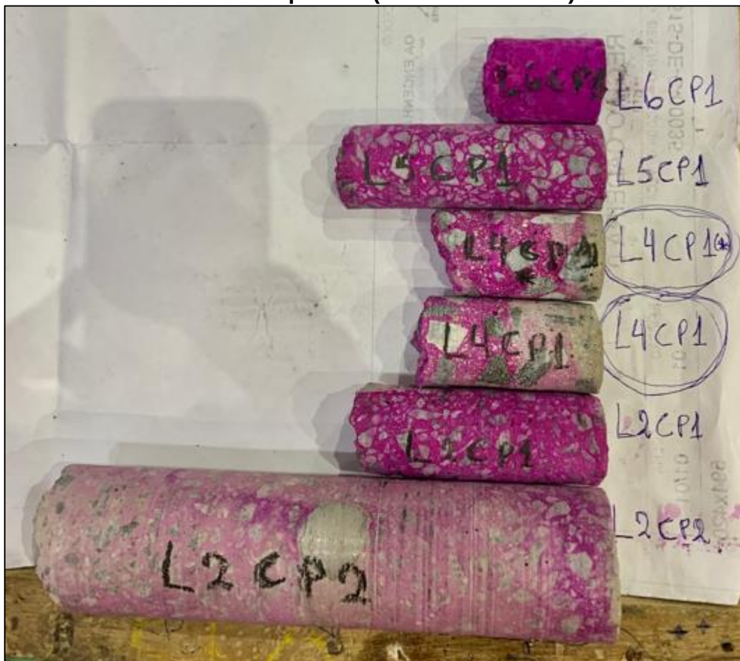
Figura 9 – identificação dos testemunhos analisados, pós aplicação de indicador químico (fenolftaleína a 1%)
