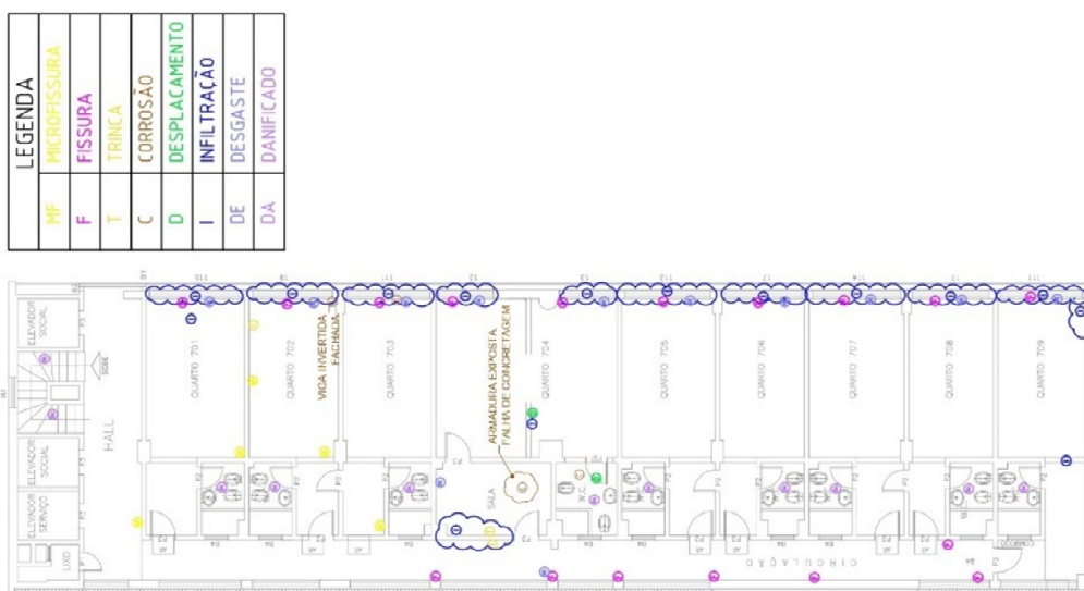
Figura 9 – Croquis com registro de não conformidades
