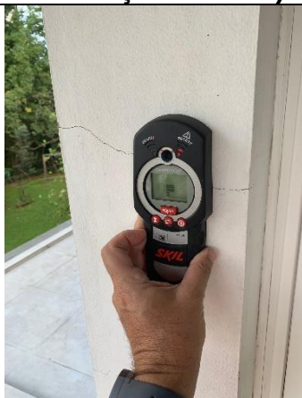
Figura 4 – Sacada frontal. Uso de detector magnético para analisar fissura presente, quanto à existência de interferências (ferragens ou instalação elétrica)
