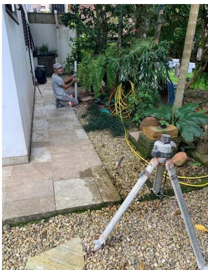
Figura 35 – Determinação de referência única de nível, por uso de nível laser, para todos os furos de monitoramento do lençol freático
