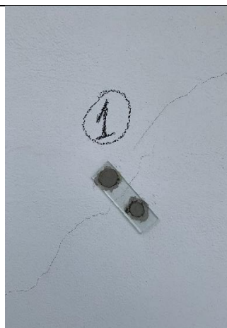
Figura 8 – Implantação de selos em vidro, para verificação do nível de atividade das fissuras
