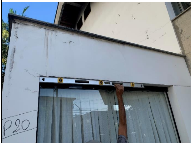
Figura 31 – Verificação de nível, na viga da laje exposta, nas proximidades do pilar P20
