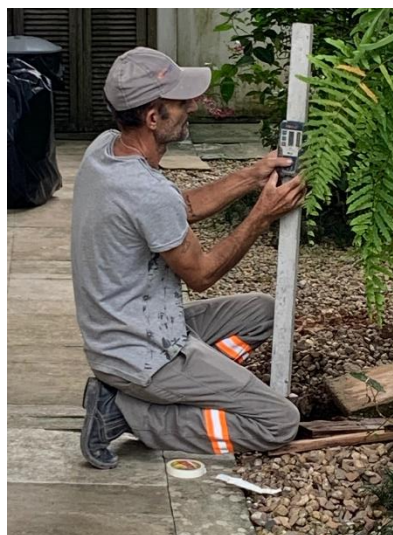
Figura 36 – Determinação de referência única de nível, por uso de nível laser, para todos os furos de monitoramento do lençol freático
