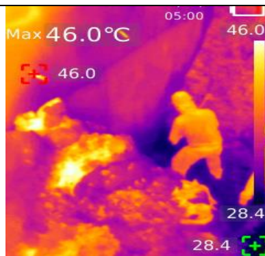
Foto: C4-010 Termografia do ponto de fuga (Azul escuro)
