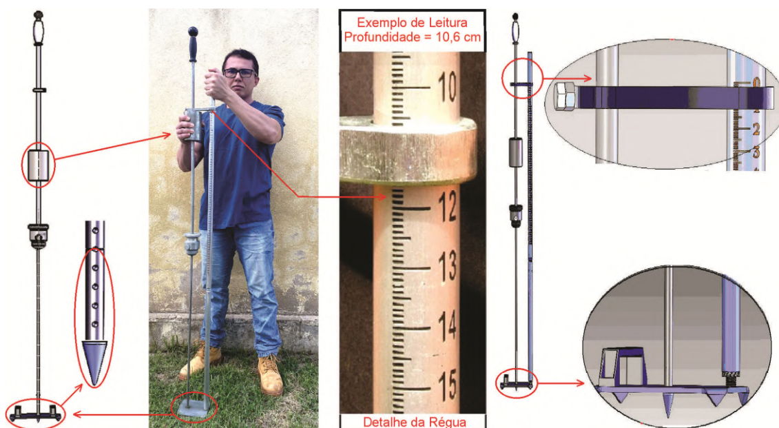
Figura 3. Detalhe esquemático do penetrômetro de impacto Stolf, modelo KAMAQ-Z70.30983. Fonte: Elaborado pelos Autores.
