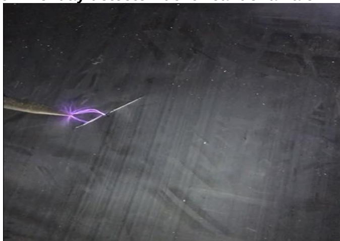
Figura 16 – Holiday detector identificando falha em manta de PEAD
