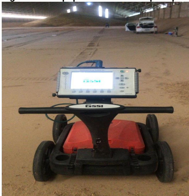
Figura 12 – Equipamento de GPR para piso
