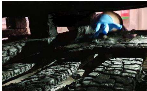
Detalhe do local de ignição do fogo entre o vão de dois pallets empilhados e retirada de material
