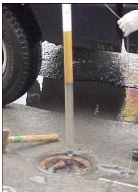
Figura 08: Exemplo de fase livre monitorada com um amostrador do tipo bailer Fonte: Adaptado de Teixeira (2013)
