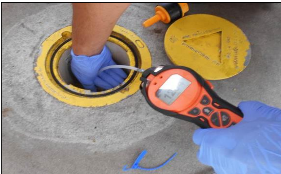
Figura 20: Leitura de compostos voláteis nas águas subterrâneas com equipamento PID (fotoionizador)
