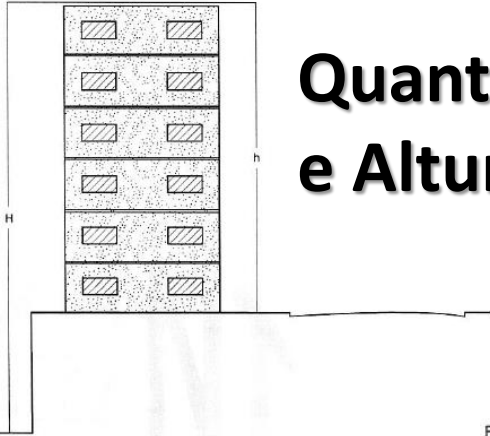
Figura 1 – Altura a ser considerada em relação ao ponto mais baixo do ter mais alta da edificação
