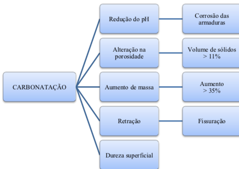
Figura 14 - Consequências mais relevantes da carbonatação no concreto
