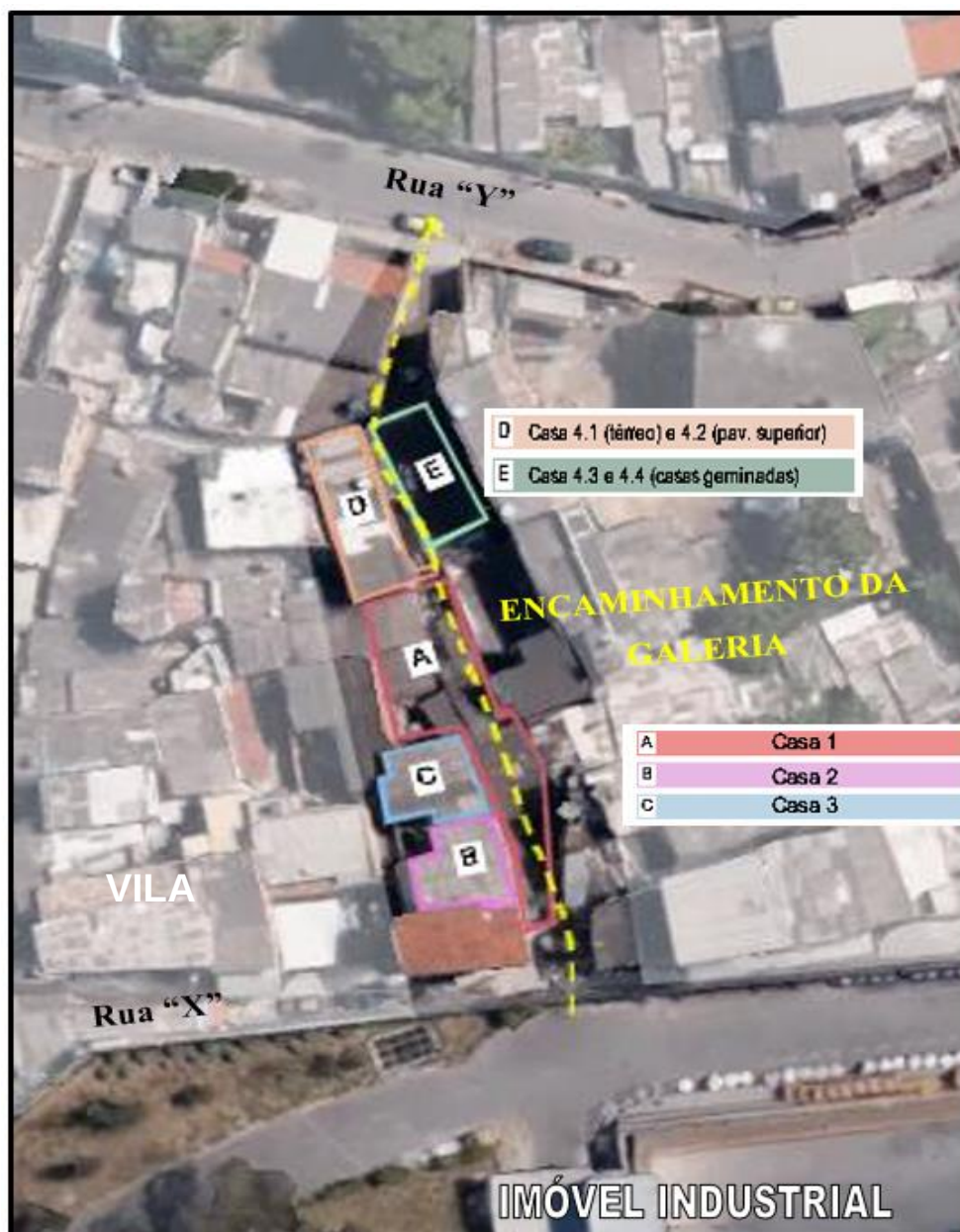
Figura 11 – Traçado da galeria de drenagem pluvial vistoriada
