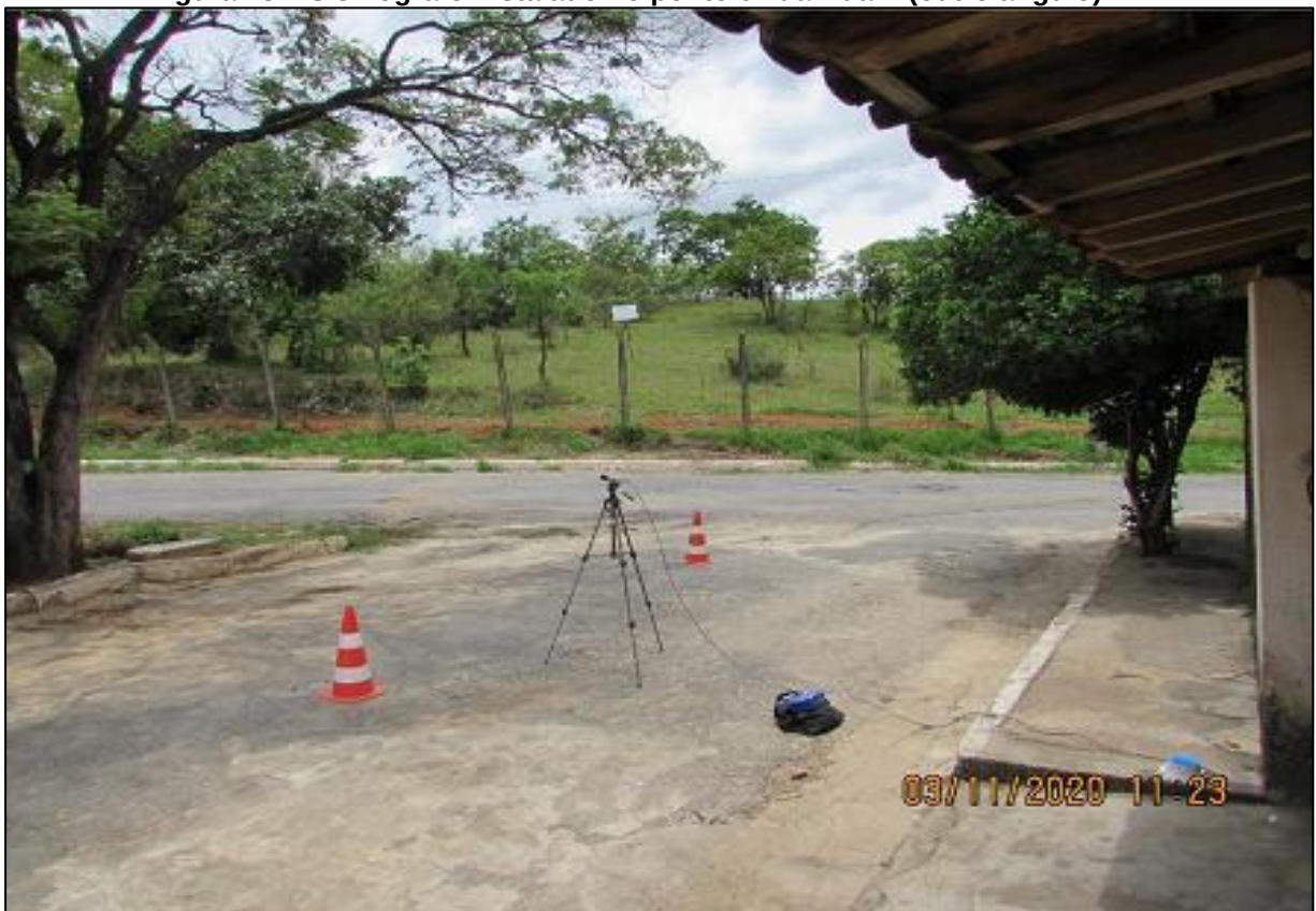
Figura 18 – Sismógrafo instalado no ponto 01 da Rua X (outro ângulo).
