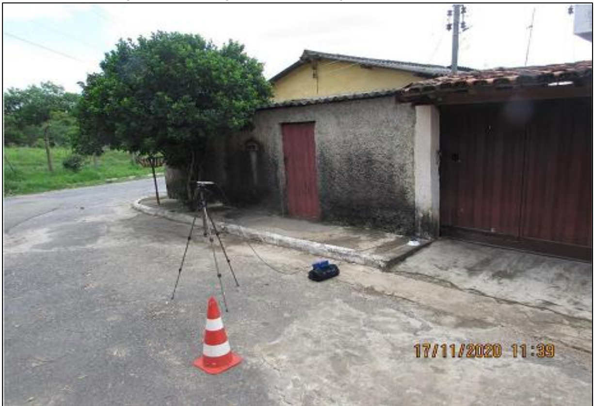
Figura 17 – Sismógrafo instalado no ponto 01 da Rua X.
