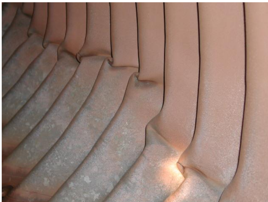
Figura 27 – Plastificação generalizada da chapa do tubo ao longo da geratriz por flexo-compressão.
