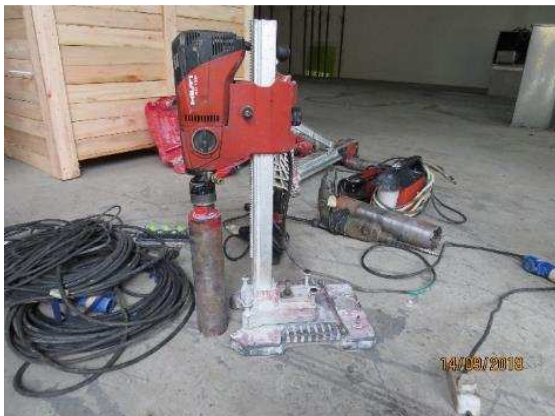
Figura 12 – Extração de testemunhos. Máquina para extração dos testemunhos modelo HILTI DD-120
