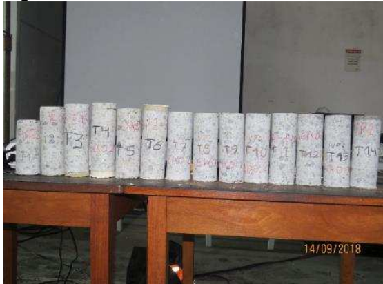
Figura 18 – Extração de testemunhos. Todos os testemunhos extraídos das vigas VP-02 Eixos 01 e 02
