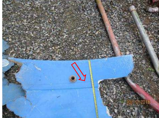
Figura 33 – Destroços dos reservatórios. Marca indicando nível de água máximo típico (seta vermelha)
