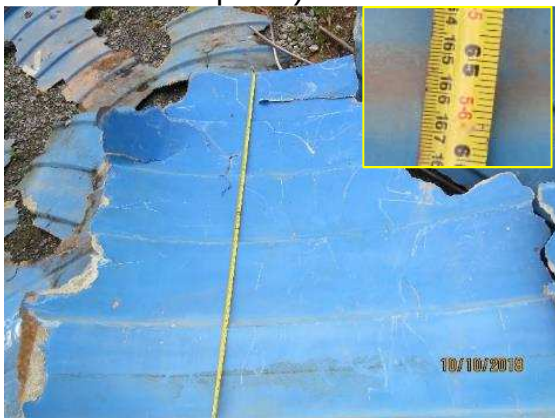
Figura 36 – Marca d'água do do nível típico do segundo reservatório (distante 165,50 cm da borda superior)
