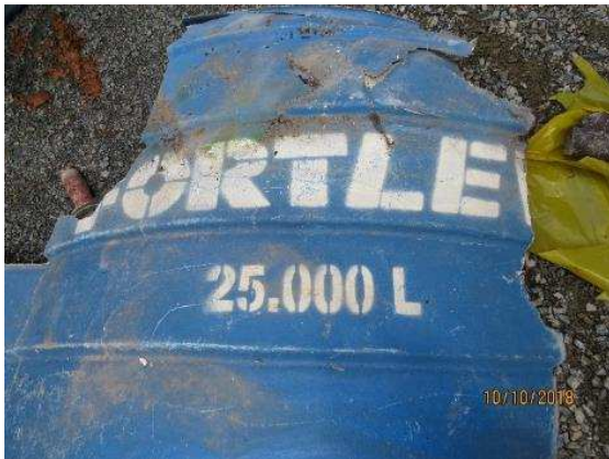
Figura 28 – Destroços dos reservatórios. Parte de um dos reservatórios de 25.000 litros
