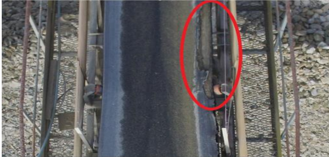
Desgaste na borda da correia do Transportador. Fonte – Acervo pessoal, 2018.
