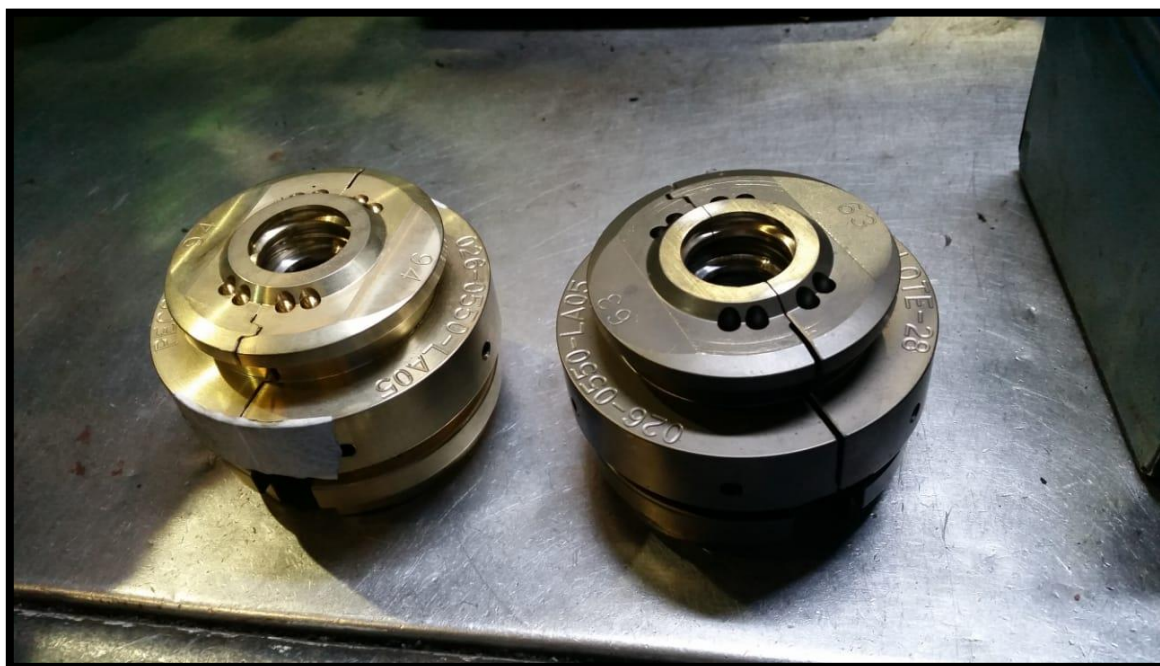
A moldagem da rosca depende da utilização de coroas metálicas conforme apresentado nas Figuras 07 e 08 a seguir. As coroas são compradas de diferentes fornecedores, que trabalham com usinagem dessas peças. Essas coroas são então distribuídas numa linha de produção com dezenas de fileiras independentes.
