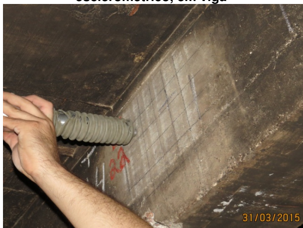
Figura 25 – SALA 09. Observar concreto com pH satisfatório somente a grande profundidade (coloração rosa)
