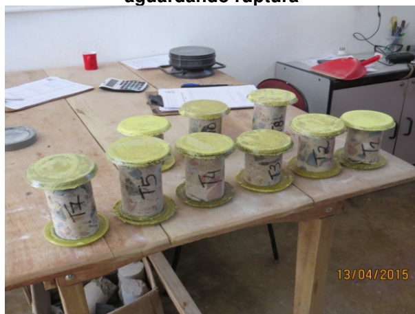
Figura 26 – LABORATÓRIO. Notar testemunhos capeados por enxofre, aguardando ruptura
