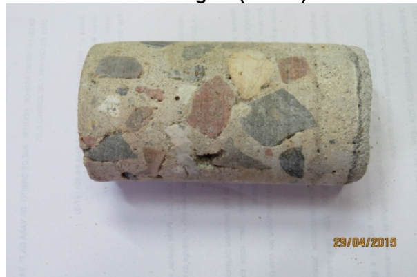
Figura 32 – SALA 09. Aferição da espessura do reboco em pilar (aprox. 1,5cm).
