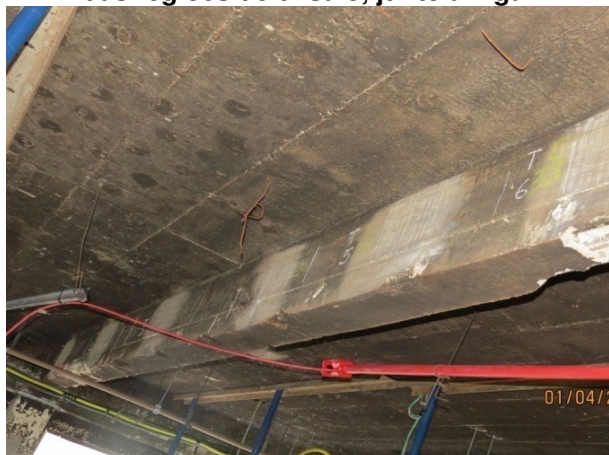
Figura 23 – SALA 09. Realização de ensaio esclerométrico, em viga
