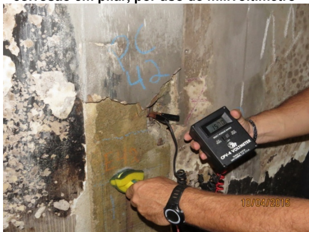
Figura 41 – SALA 09. Análise de potencial de corrosão em pilar, por uso de milivoltímetro
