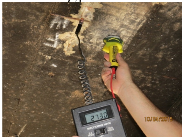
Figura 42 – SALA 09. Análise de potencial de corrosão em laje, por uso de milivoltímetro
