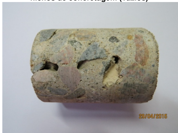
Figura 31 – TESTEMUNHO 14. Observar nichos de concretagem (vazios)
