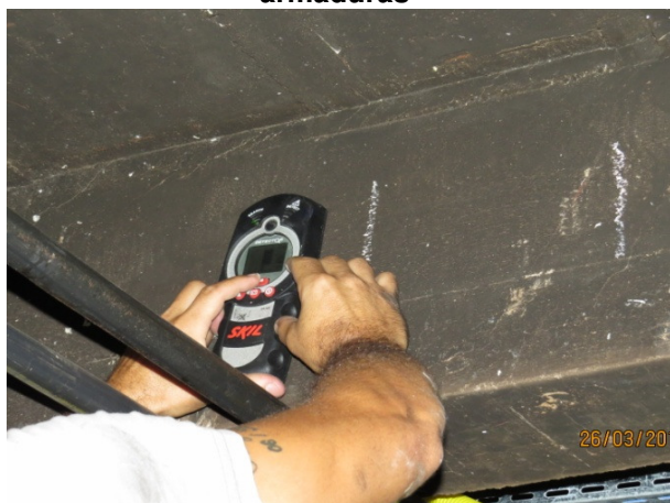
Figura 19 – SALA 09. Uso de detector magnético (pacômetro), para localização de armaduras
