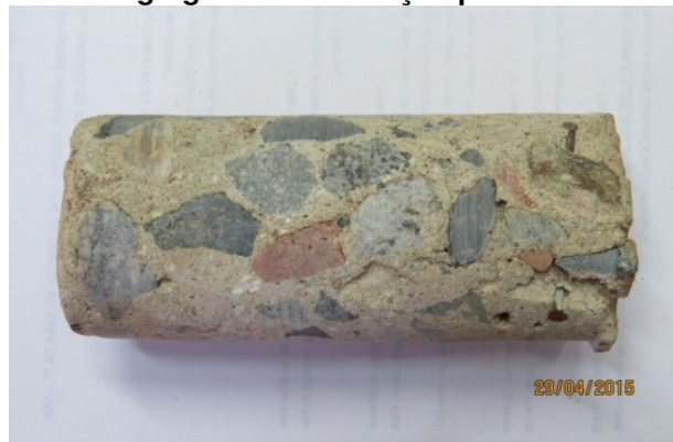
Figura 31 – TESTEMUNHO 14. Observar nichos de concretagem (vazios)
