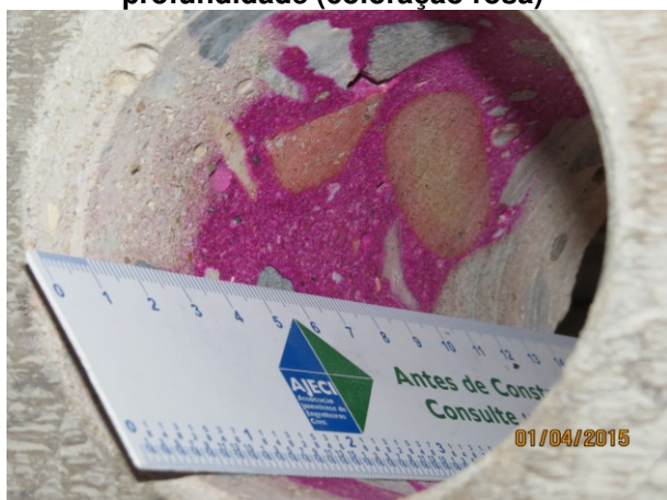
Figura 25 – SALA 09. Observar concreto com pH satisfatório somente a grande profundidade (coloração rosa)
