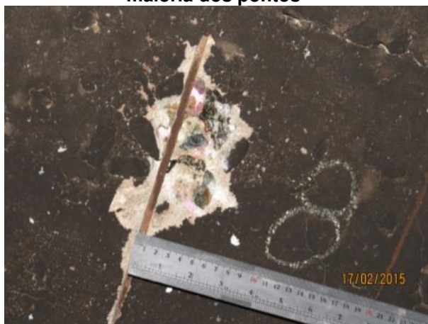
Figura 11 – SALA 09. INSPEÇÃO ESTRUTURAL. No detalhe, ponto 08 localizado em laje, apresentando pH insatisfatório (ausência de coloração rosa), baixo cobrimento e armadura íntegra (CA 60, aço laminado a quente). A situação encontrada neste ponto da laje se repete na maioria dos pontos
