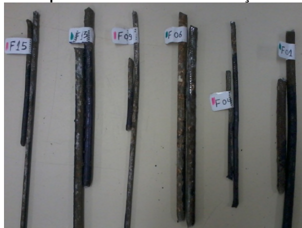
Figura 38 – LABORATÓRIO. Notar amostras após ensaio de resistência a tração
