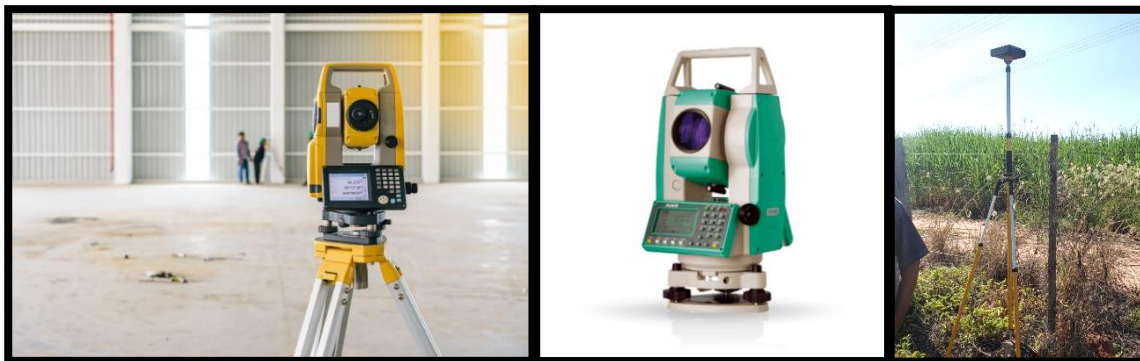
Figura 4 - Teodolito, Estação Total e GPS. Fonte: Freepik, Alezi Teodolini e Autor.
