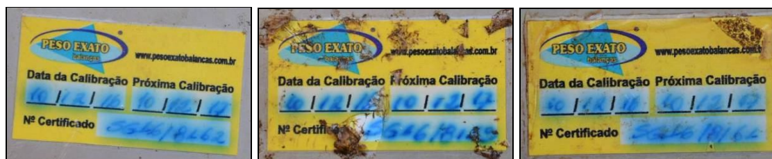
Imagens 08 a 10: vista das etiquetas dos manômetros, indicando a data da próxima calibração (10/12/2017), ou seja, os manômetros estavam com a calibração vencida no dia do sinistro.
