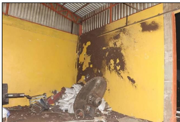
Imagens 03 e 04: à esquerda observa-se a posição final do tampo do digestor, distante 27 metros do casco, bem como a integridade do tampo. À direita, detalhe do tampo do digestor com seccionamento de parte para realização de ensaios de composição e resistência.
