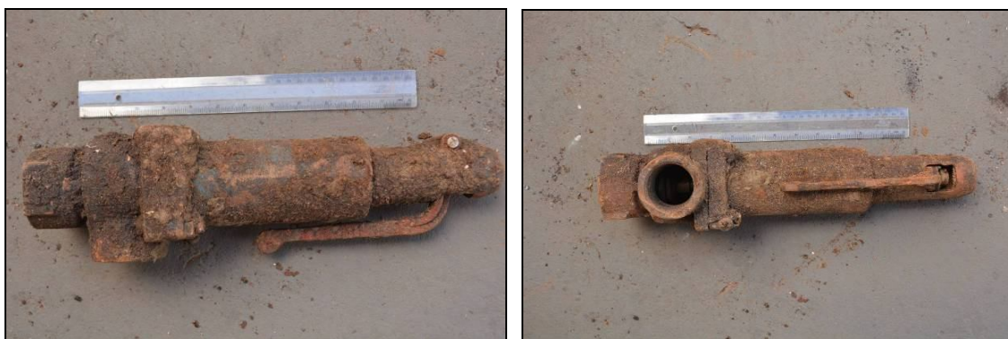
Imagens 11 e 12: vistas da válvula de segurança, nas condições em que foi recuperada dos escombros.
