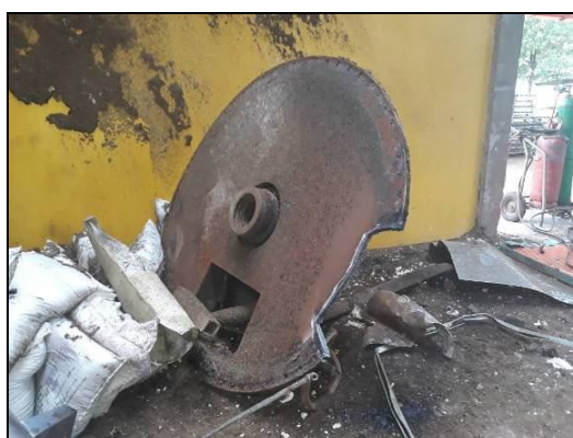
Imagens 03 e 04: à esquerda observa-se a posição final do tampo do digestor, distante 27 metros do casco, bem como a integridade do tampo. À direita, detalhe do tampo do digestor com seccionamento de parte para realização de ensaios de composição e resistência.
