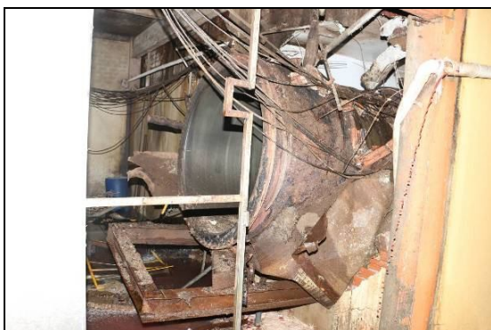
Imagens 01 e 02: a imagem à esquerda indica a posição final do digestor, depois da explosão, enquanto na imagem à direita se observa a completa integridade do casco do digestor.
