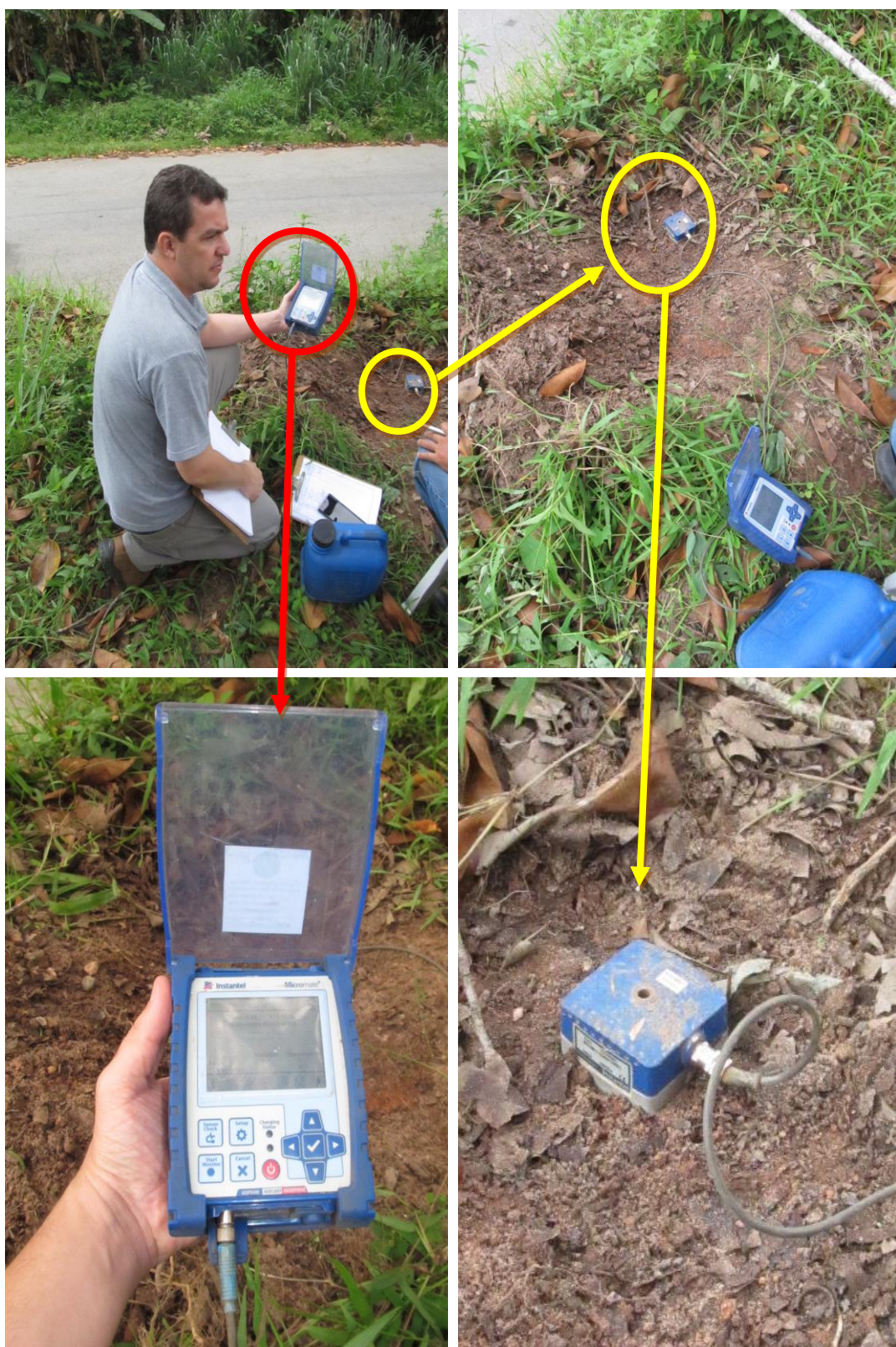
Figura 8 - Imagens mostrando os equipamentos utilizados para a medição das vibrações nos 15 (quinze) pontos de monitoramento (geofones). Fonte: Elaborada pelos autores.
