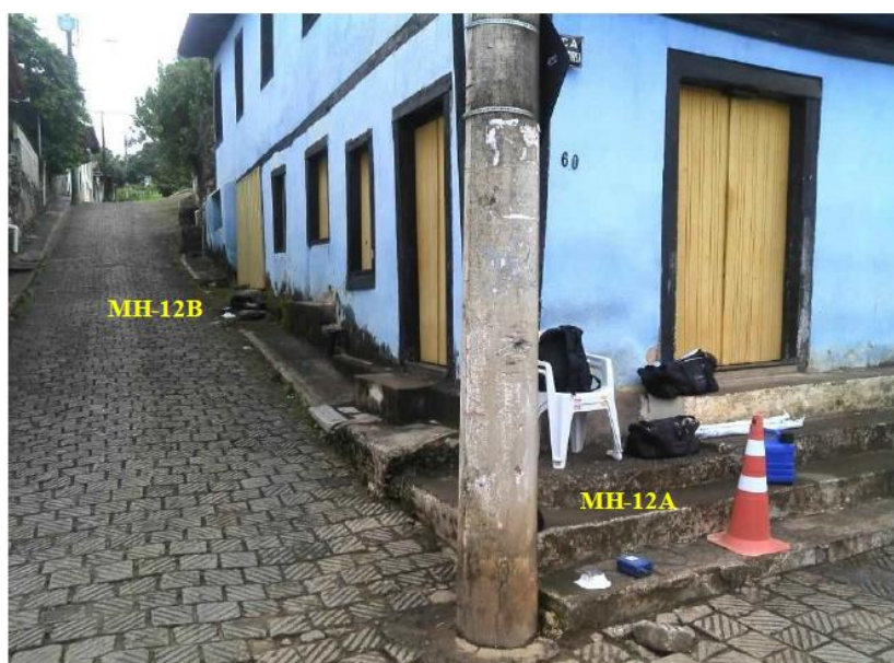
Figura 13 - Vista do posicionamento do ponto MH-12B na via secundária a 11m do ponto MH-12A situado na esquina com a via principal onde trafegaram as fontes móveis cujas vibrações foram registradas.
