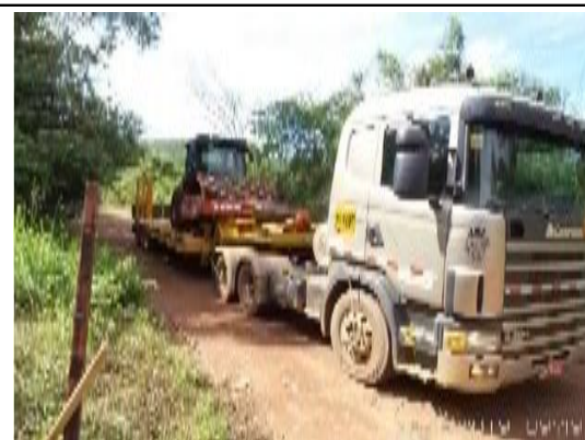
CONJUNTO CAMINHÃO SCANIA R420 COM PRANCHA + ROLO COMPACTADOR DYNAPAC CA250 – PESO BRUTO TOTAL DO CONJUNTO 66 T
