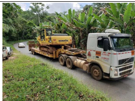
CONJUNTO CAMINHÃO VOLVO 420 COM PRANCHA + RETROESCAVADEIRA HIDRÁULICA KOMATSU PC 200 – PESO BRUTO TOTAL DO CONJUNTO 76 T;
