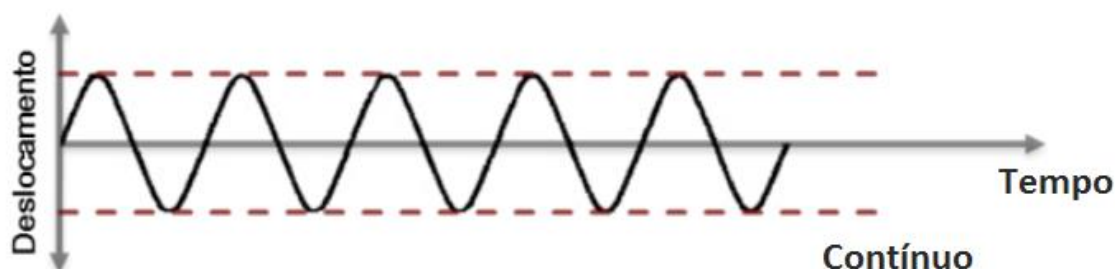
Figura 4 - Classificação das vibrações sísmicas – vibração contínua. Fonte: (CECAV, 2016).
