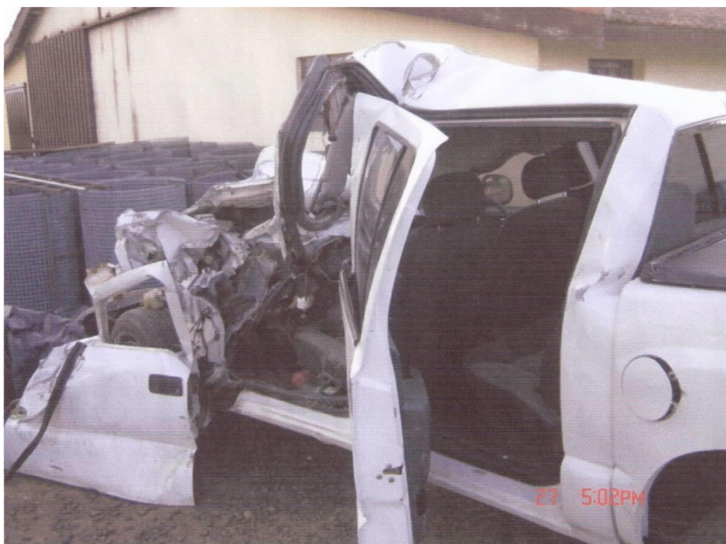
Foto 3 – Vista do teto todo deformado
