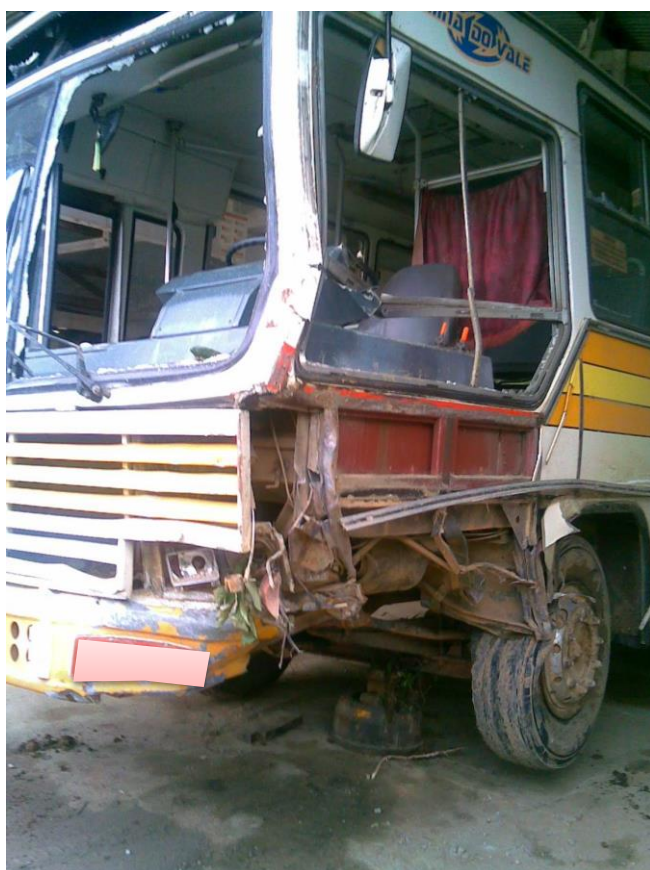
Foto 9 – Detalhe das deformações no setor angular posterior esquerdo na altura do terço interior, e arrancamento de parte da lateral anterior esquerda no terço médio e detalhe da deformação na coluna dianteira esquerda no terço superior
