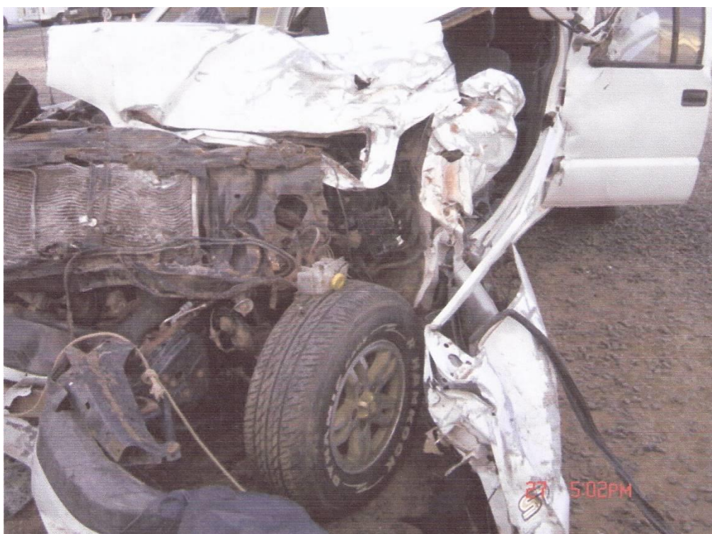
Foto 2 – Vista da S10 após o acidente, detalhe das deformações no setor angular anterior esquerdo, na altura do terço médio (foto enviada pelo Assistente Técnico).
