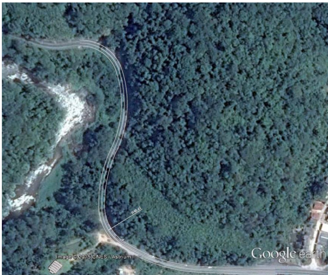
Figura 18 – Determinação do raio da curva através de desenho CAD sobre imagem de satélite, resultando em um raio de 48,42m para a curva em questão.
