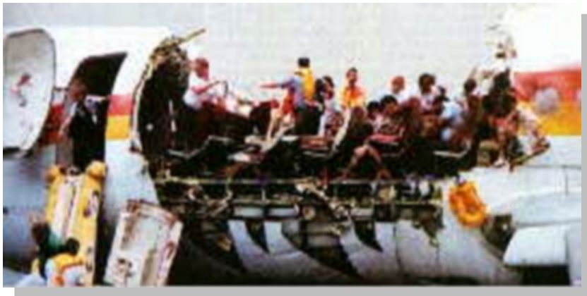
Delaminação da fuselagem do B737
